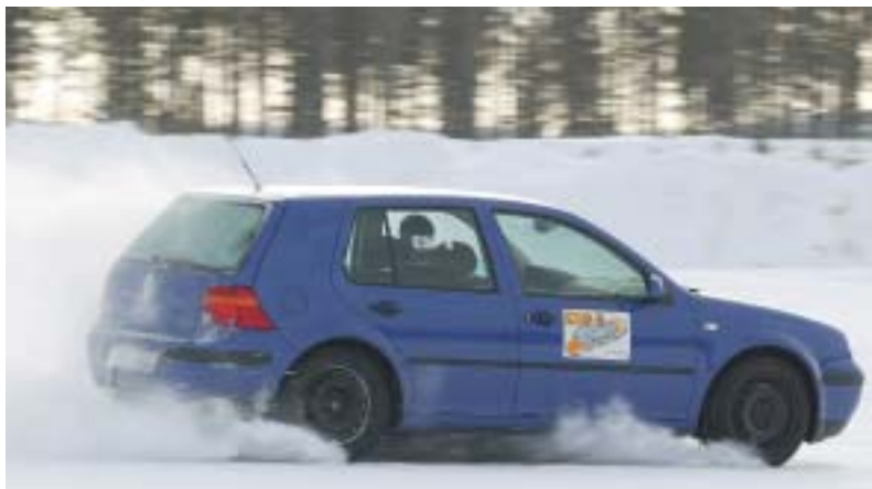
▲ Das Prototypenfahrzeug mit ESP II meistert die schwierigsten Fahrmanöver bei der Wintererprobung in Nordschweden.
